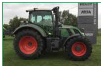
FENDT 716 PROFI SCR 2300h - 2014 - 160CV - RELEVAGE AVT PONT AVT SUSP-3E PT HYD 3DECARR 1 AVT-LS- PRISE ISO-RETRO GRD ANGLE-CLIM AUTO
